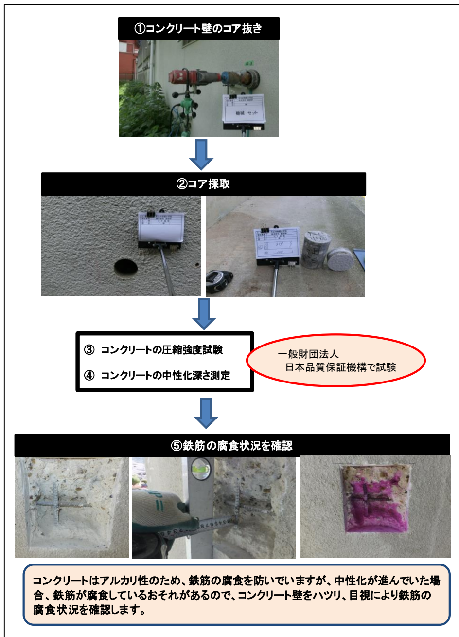
【図表2 鉄筋コンクリート造構造体劣化調査】
