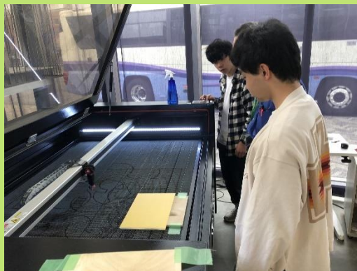
3D 造形先端加工センターでの名称板・誘導標識レーザー加工の様子
